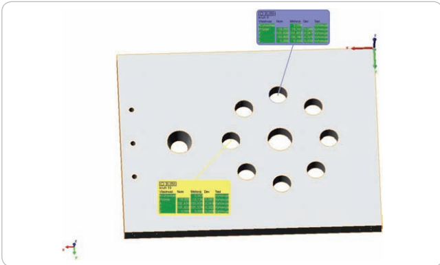
Obr. 6 Príklad merania náhradného dielu v 3D so zápisom nameraných hodnôt
