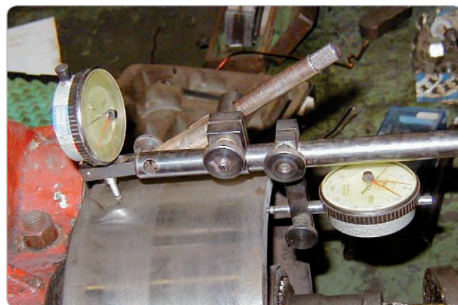
Obr. 3 Nastavenie rotačných zariadení pomocou číselníkového odchýlkomera
