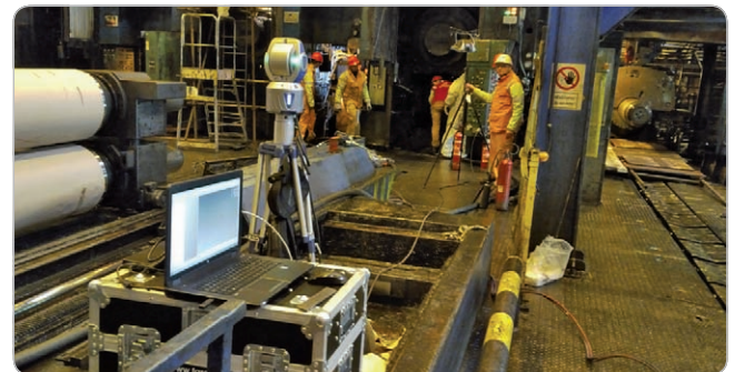
Obr. 9 Zameranie rovnobežnosti stressometrického valca a 5. stolice 5STT
