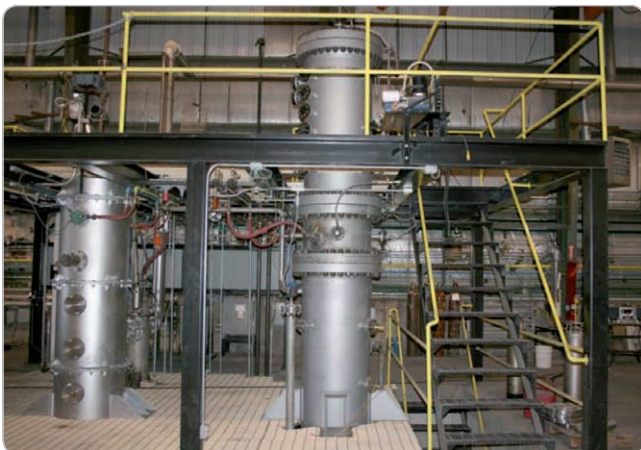
Obr. 1 Tlakové fluidné splyňovacie lôžko spracúva pevné palivá (napríklad biodpad) a slúži na preskúmanie reaktivity paliva, analýzu tvorby dechtu a kvality syntetického plynu
