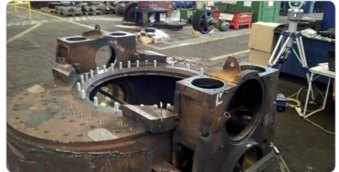
Obr. 8 Zameranie otvorov prevodoviek sklápania na rotačnom rozdeľovača Paul Wurth VP2
