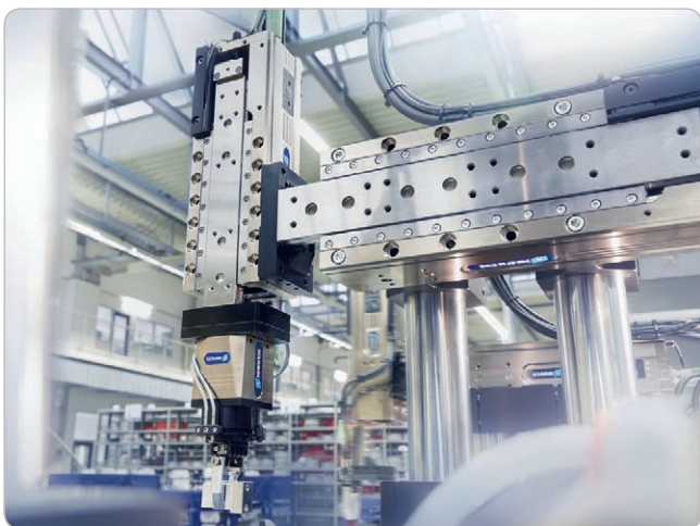
Obr. Vďaka samoučiacej funkcii nemusíte mať o mechatronike žiadne odborné znalosti pri uvádzaní kompaktného lineárneho modulu SCHUNK ELP do prevádzky. Pohon a riadenie sú plne integrované do osí
