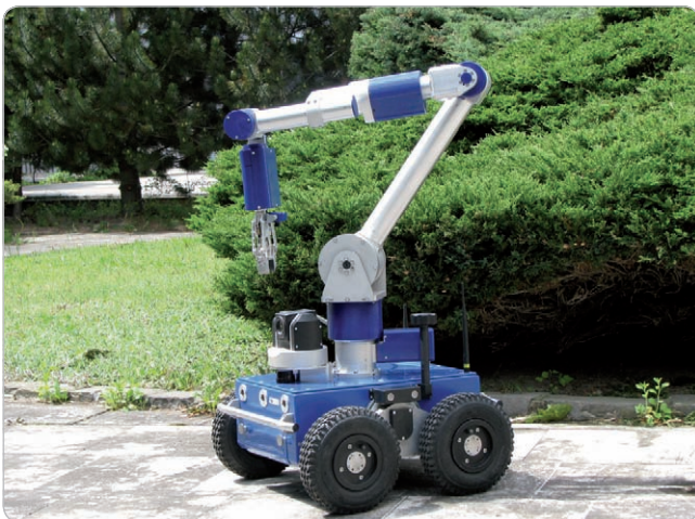
Obr. 1 Mobilný robotický systém MRVK s robotickým ramenom
