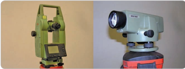
Obr. 5 Nastavenie výrobných zariadení pomocou teodolitu a nivelačného prístroja
